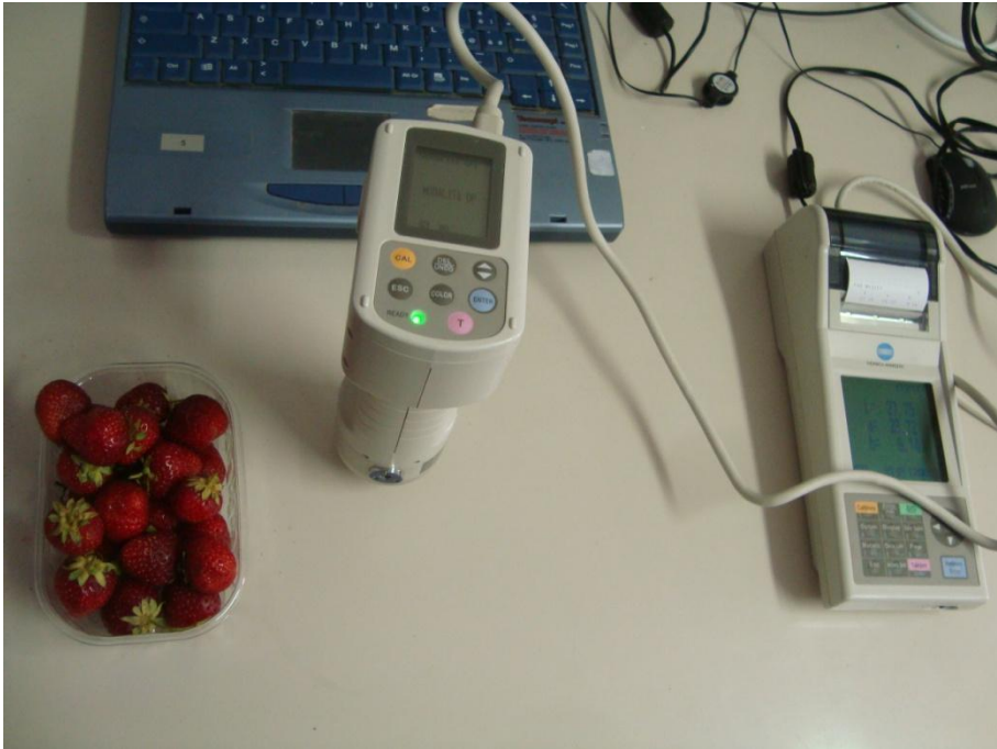
Fig. 4. La colorazione della superficie del frutto è stata determinata mediante colorimetro digitale.
